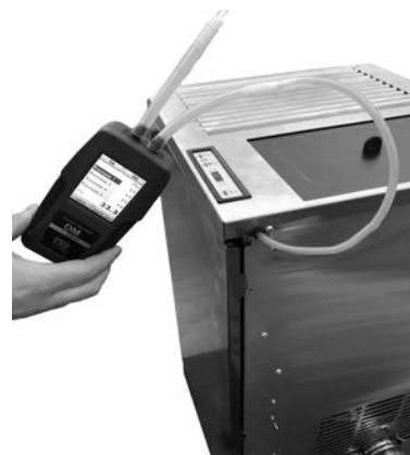
Fig. 27 - Aansluiting digitale drukregelaar
