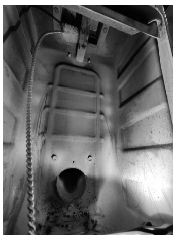
Fig. 33 - Reinig met pijpenwisser
