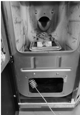
Fig. 31 - Reinig met pijpenwisser
