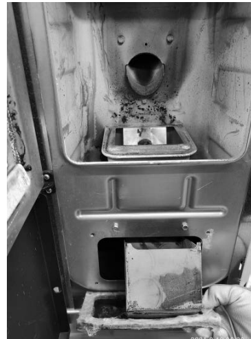
Fig. 30 - Verwijder de inspectiedop
